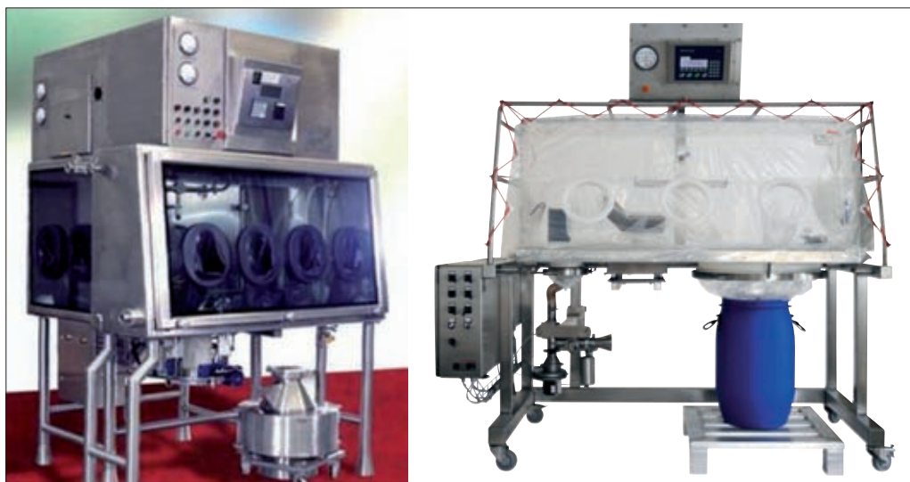
Der Trend geht von „starren“ (li.) hin zu „flexiblen“ Containment-Systemen (re.), hier am Beispiel von Isolatoren
