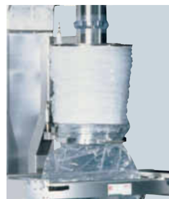
Befüllstation mit Endlosliner
