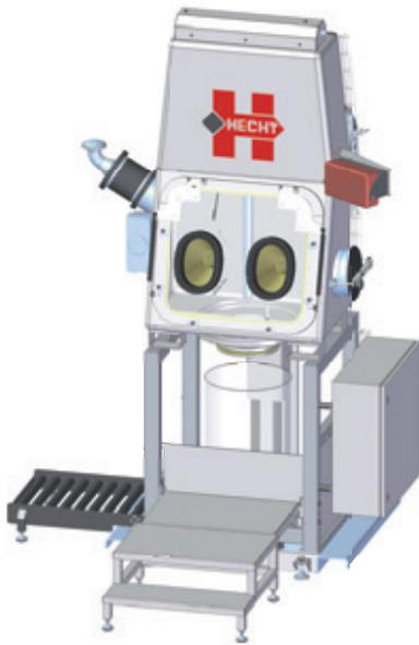
Die **Containment Fassentleerung mit Lanze Typ CFE-L** von HECHT wird für eine geschlossene Entleerung von Fässern mit Inliner bis OEB 5 verwendet.
