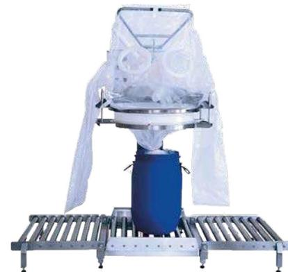
Ob Probenahmen für Wareneingangs- und -Ausgangskontrollen, für Labortests oder weitere Bereiche der Qualitätssicherung: Das innovative Einweg-Probenahme-System (EPS) von HECHT ermöglicht die Bemusterung von hochaktiven oder hochgefährlichen Produkten aus Kleingebinden ohne aufwändige Schutz- und Reinigungsmaßnahmen.
