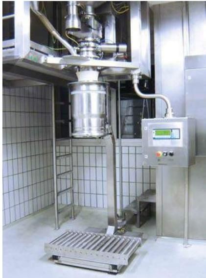
Beim **Löffelprobenehmer von HECHT** handelt es sich um ein wahlweise pneumatisches oder per Hand angetriebenes Inline-Probenahmesystem mit flexiblem Probenahmebehältnis (Löffel).
