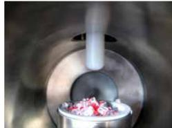
Voller Löffel mit Probe fährt in das Probennehmergehäuse.
