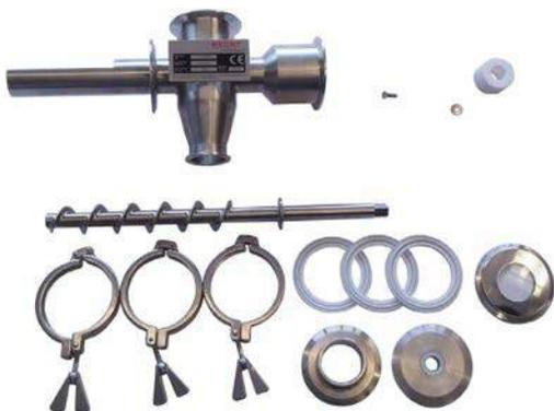
Die in den Materialfluss hineinragende Probenahmeschnecke entnimmt einen repräsentativen Produktquerschnitt aus dem Produktfluss und fördert diesen in ein Probengefäß.
