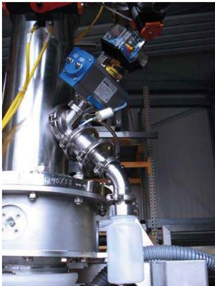
Der **Vakuumprobenehmer** von HECHT ermöglicht eine geschlossene, automatische Inline-Bemusterung von Pulvern und Granulaten aus einer Produktsäule.
